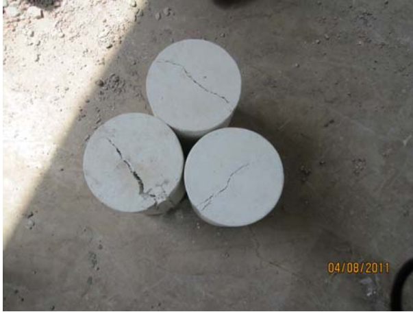
Resim 2. Yarmada Çekme Testi
